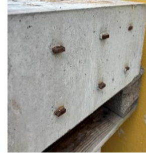
Béton C50 fer plat \varnothing 12 mm d'épaisseur
