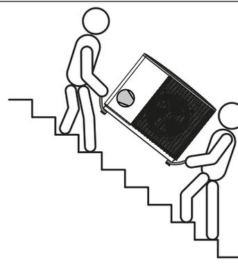
Si l'appareil est incliné pendant la manutention (jusqu'à 45°), cette position doit être temporaire et porter uniquement sur l'un des côtés longitudinaux. Transportez l'appareil de manière à ce que le compresseur se retrouve du côté le plus haut de l'appareil.
