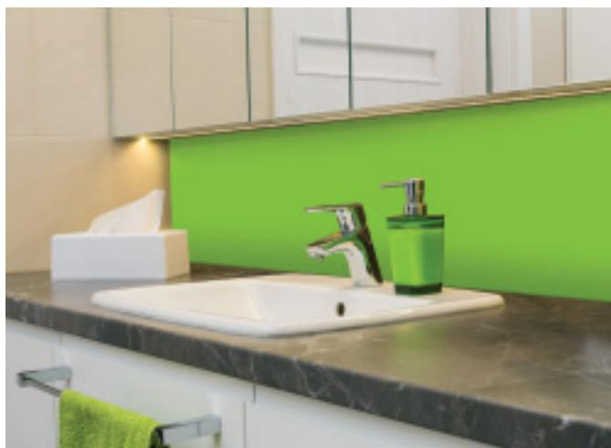
Complexe en matériau composite constitué de deux feuilles d'aluminium recouvertes d'une laque avec une âme en polyéthylène. Matériau spécialement conçu pour les milieux humides ; les composants de ce produit lui permettent d'être léger, rigide et étanche.
