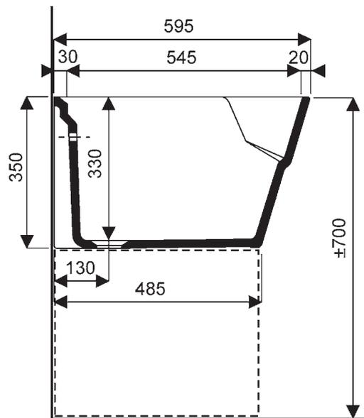
Pose recommandée sur jambages maçonnés (carreaux de plâtre hydrofuges, briques plâtrières, etc...).
