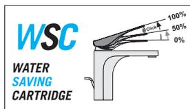
Le système "point dur" oppose une résistance à l'ouverture de la manette, réduisant ainsi le débit d'environ 50%, tout en conservant un confort d'utilisation.
