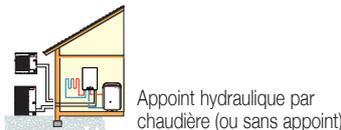
Les PAC œnoviaPac Colonne-2C V200 ou H V200 sont composées d'une unité extérieure (voir p. 10) et d'un module intérieur MHX-4 V200 (Module InVerter-4) monté avec un préparateur d'eau chaude sanitaire de 180 litres. La cuve en acier du préparateur d'eau chaude sanitaire est équipée d'une anode en magnésium et est revêtue intérieurement d'un émail vitrifié,
