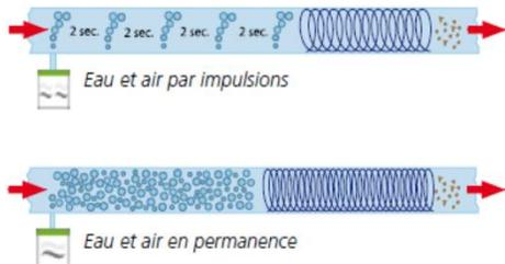
Pour les radiateurs, les systèmes de planchers chauffants et les conduites d'eau potable
