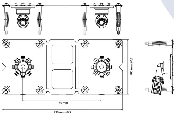
Les raccords s'emboîtent à la plaque, garantissant un positionnement stable, et se fixent grâce à un écrou.
