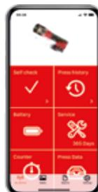
Grâce à l'application ROTHENBERGER, l'outil et le smartphone peuvent être connectés, permettant ainsi à l'utilisateur d'accéder en temps réel aux données pertinentes de la machine et des sertissages. De plus, l'application facilite la création rapide et simple de protocoles sur place, avec une logique intelligente, et permet de consulter l'état de maintenance de l'outil.
