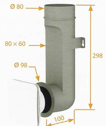
Destiné à être installé derrière une cloison, la bouche étant placée à environ 20 cm du plafond. Le manchon coudé Ø 80 est équipé de deux pattes de fixation. La bouche se monte par simple emboîtement.
