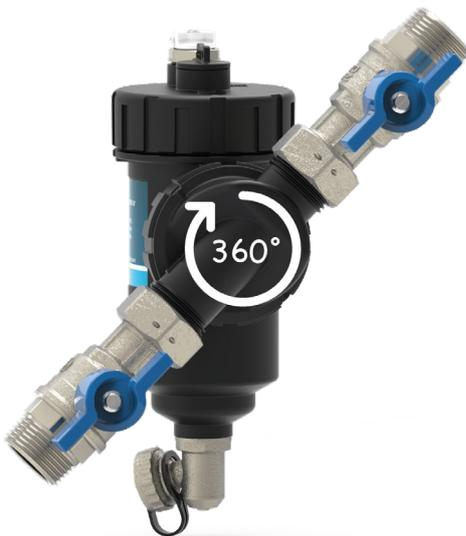
Une caractéristique spécifique de la série EvoMAGic 103 est l'adaptabilité d'installation. Bien qu'il doive être installé avec l'axe principal en vertical, il peut être installé sur tubes de différentes directions (vertical, horizontal et aussi en oblique) grâce au raccord té orientable de 360°. Il faut absolument respecter des règles de base de correcte installation. Pour plus d'information, se référer au paragraphe spécifique INSTALLATION.
