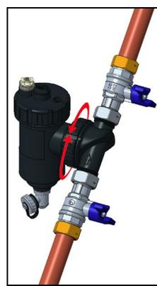
Grâce à la connexion pivotante à 360°, à l'aide de la clé spécifique fournie, l'installation sur des tuyaux qui court verticalement, horizontalement ou inclinés est facile. Évitez toute position d'installation avec l'axe du filtre séparateur magnétique placé horizontalement, en diagonale ou même à l'envers.
